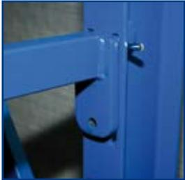
Mit dem Einhängen ruht der Kragarm in seiner Position. Der Kragarm muss nur geringfügig angehoben werden; darüber im Regal eingehängte Kragarme müssen zum Umhängen nicht extra ausgehängt werden. Ein Sicherungsstift verhindert beim Ausweichen des Kragarms dessen Herausrutschen aus der Ständerlochung.
