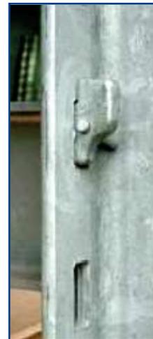
Dieser Kragarm weicht auch starken Stößen durch den Gabelstapler – **sowohl in der Höhe, wie auch seitlich** – aus und kehrt sofort wieder in seine Ausgangsstellung zurück. So werden Lagerware und Regal geschont. Der einhängbare Kragarm hat eine speziell geschmiedete Kopfplatte, deren Haken selbst höchste Lasten tragen.
